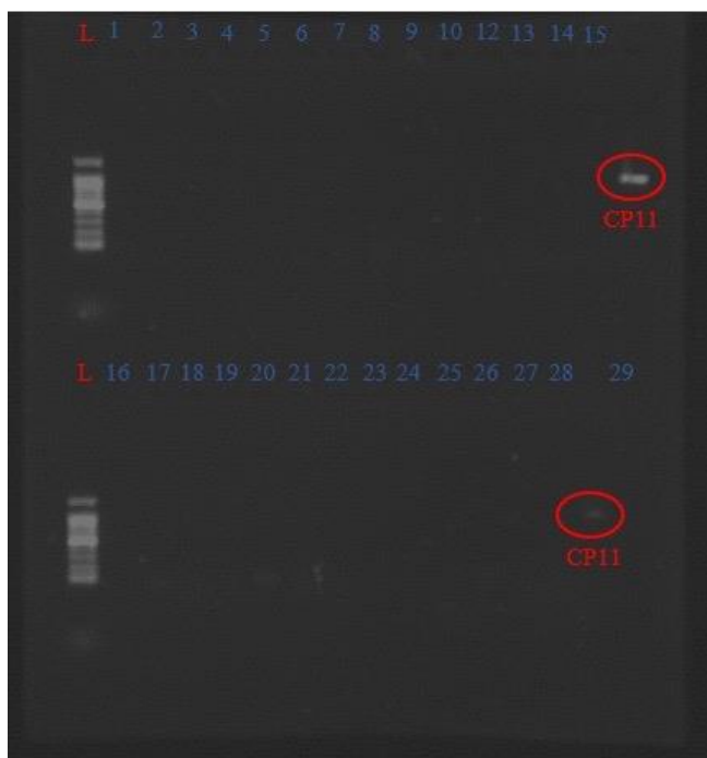
Slika 14. Prikaz rezultata elektroforeze uzoraka DNA umnoženih nested PCR reakcijom (0 h Š 1 – 30). Pozitivna kontrola (DNA referentnog uzorka Cryptosporidium parvum , CP11) obilježena je crvenim krugom i oznakom CP11. *L-biljeg
