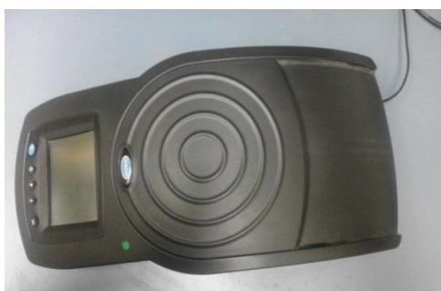
Slika 3.4.3. Spektrofotometar Hach DR2500 (izvor fotografije: Matea Vlašić)
