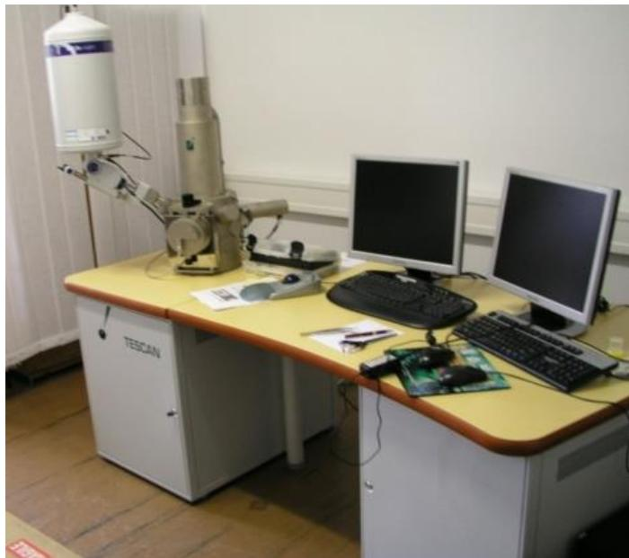
**Slika 2.3.8.1.** Skenirajući elektronski mikroskop Tescan Vega TS5136LS
