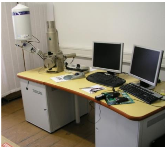
Slika 2.3.8.1. Skenirajući elektronski mikroskop Tescan Vega TS5136LS (izvor: Suzana Jakovljević).
