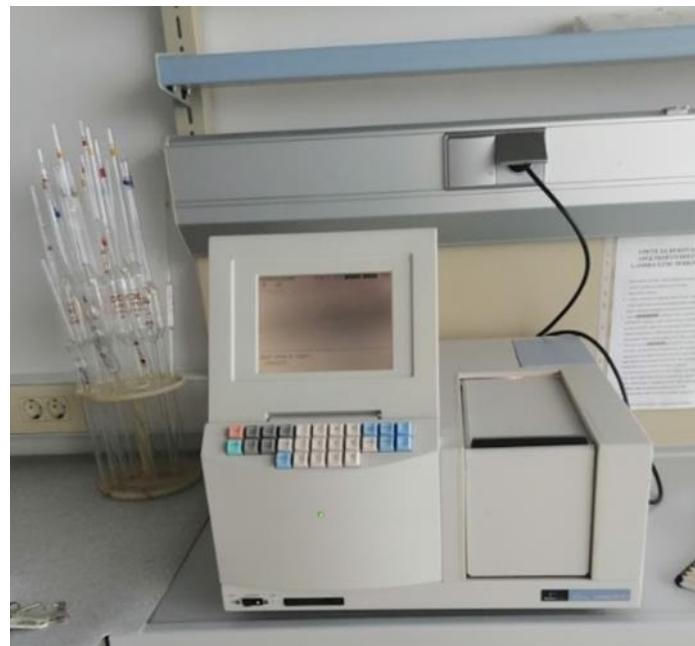
**Slika 14.** Spektrofotometar.
