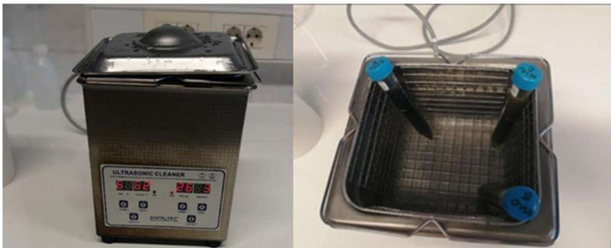
**Slika 12.** Ultrazvučna kupelj s uzorcima.
