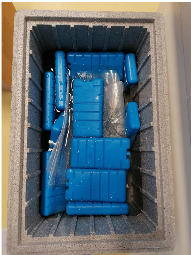
Slika 4. Šokiranje pasteriziranih uzoraka u hladnoj kupelji (izvor: vlastita fotografija).
