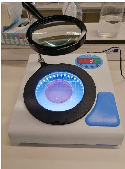
**Slika 8.** Uređaj za brojanje kolonija (izvor: vlastita fotografija).
