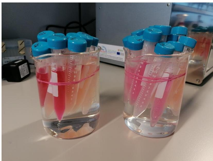
**Slika 12.** Hladenje uzoraka (izvor: vlastita fotografija).
