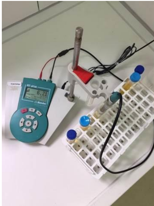
Slika 11. Mjerenje pH pomoću pH metra.
