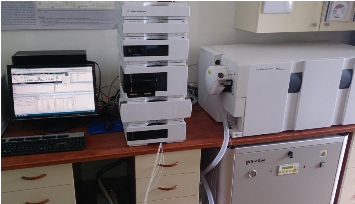
Slika 13. Vezani sustav tekućinski kromatograf i maseni spektrometar, Agilent Technologies: trostruki kvadrupol - Triple Quad 6410, odzračivač - Degasser 1200, kvaterna pumpa - Quaternary Pump 1200, automatski uzorkivač - Auto sampler 1290 i termostatirano kućište za kolonu - Thermostatted Column Compartment 1290.
