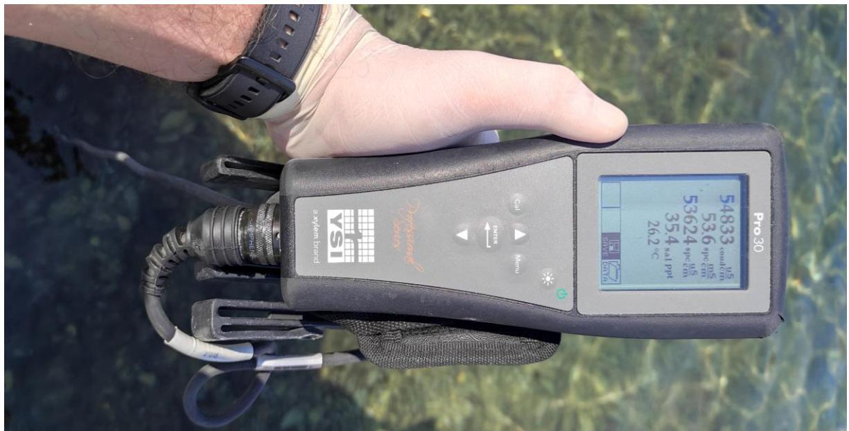
**Slika 7.** Očitavanje rezultata mjerena ručne sonde pri prikupljanju uzorka na terenu
