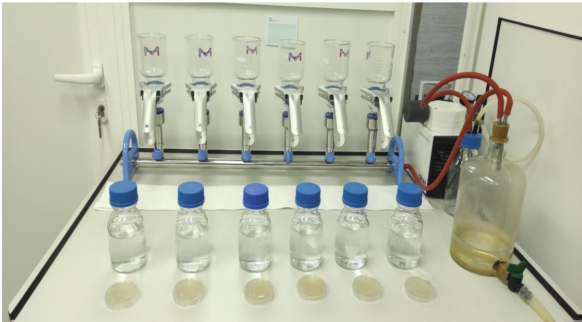
**Slika 8.** Filtracijska aparatura
