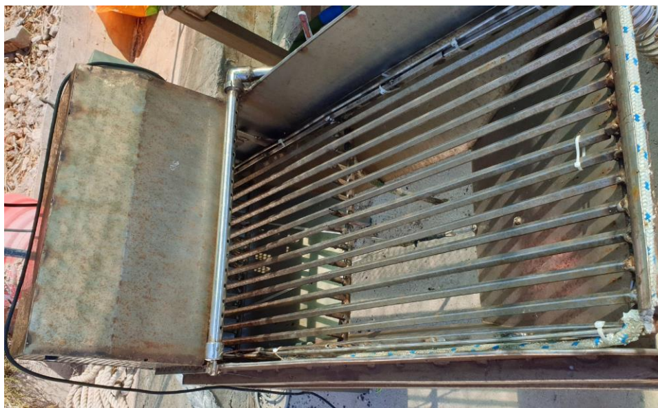
Slika 11. Željezna rešetka za selektiranje dagnji (foto: Nika Prelević).
