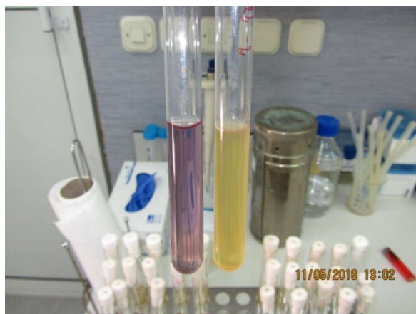
Slika 15. Prikaz pozitivne (žuto obojenje) i negativne (ljubičasto obojenje) reakcije u epruvetama prilikom detekcije E. coli .
