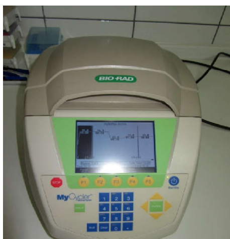
Slika 11. PCR uređaj – termocikler (Bio-Rad).
