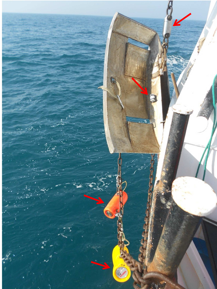
Slika 3.7. Širilica V profila na koju je pričvršćen Star Oddi minilog senzor za kontrolu kutova širilica. Na uzdama širilice nalaze se SIMRAD (žuti) i SCANMAR (narančasti) senzori kojima se kontrolira udaljenost između širilica, a povlačna užad sa širlicom je spojena preko dinamometra kako bi se pratio otpor mreže tijekom povlačenja.
