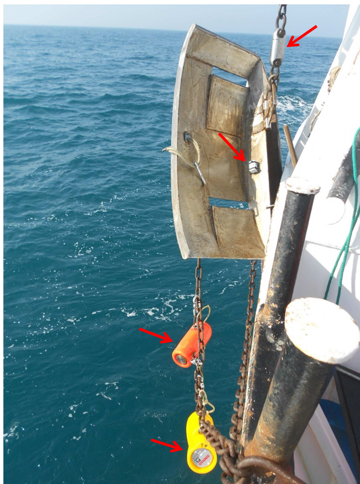
Slika 3.7. Širilica V profila na koju je pričvršćen Star Oddi minilog senzor za kontrolu kutova širilica. Na uzdama širilice nalaze se SIMRAD (žuti) i SCANMAR (narančasti) senzori kojima se kontrolira udaljenost između širilica, a povlačna užad sa širilicom je spojena preko dinamometra kako bi se pratio otpor mreže tijekom povlačenja.
