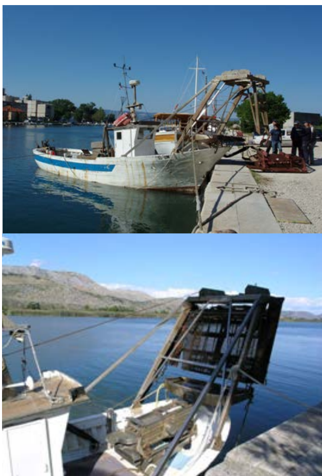
Slika 3.8.1. Hidraulična dredža (Izvor fotografija: Igor Isajlović).
