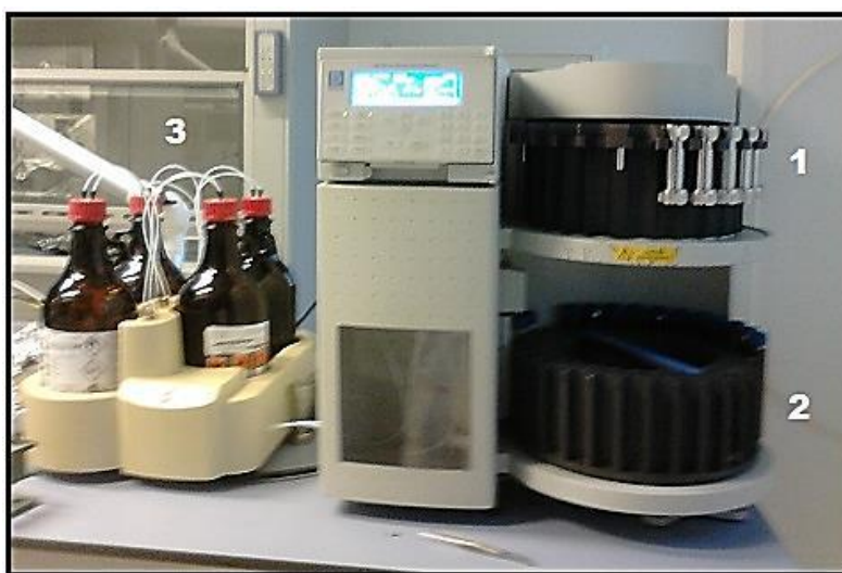
Slika 3.4.2.2. Uređaj za ekstrakciju otapalom pod visokim tlakom (ASE): 1) ćelije za ekstrakciju s uzorkom 2) epruvete za skupljanje ekstrakta 3) otapala za ekstrakciju.
