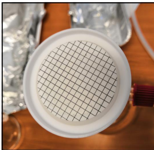
Slika 10. Membranski filter za filtriranje destilirane vode (slika: Z. Popović Perković).
