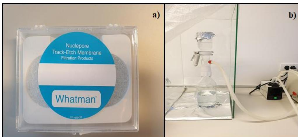
**Slika 17.** a) Membranski filter Whatman, promjera  $2\mu\text{m}$  b) Filtriranje suspenzije kroz membranski filter (slika: E. Vranjić).
