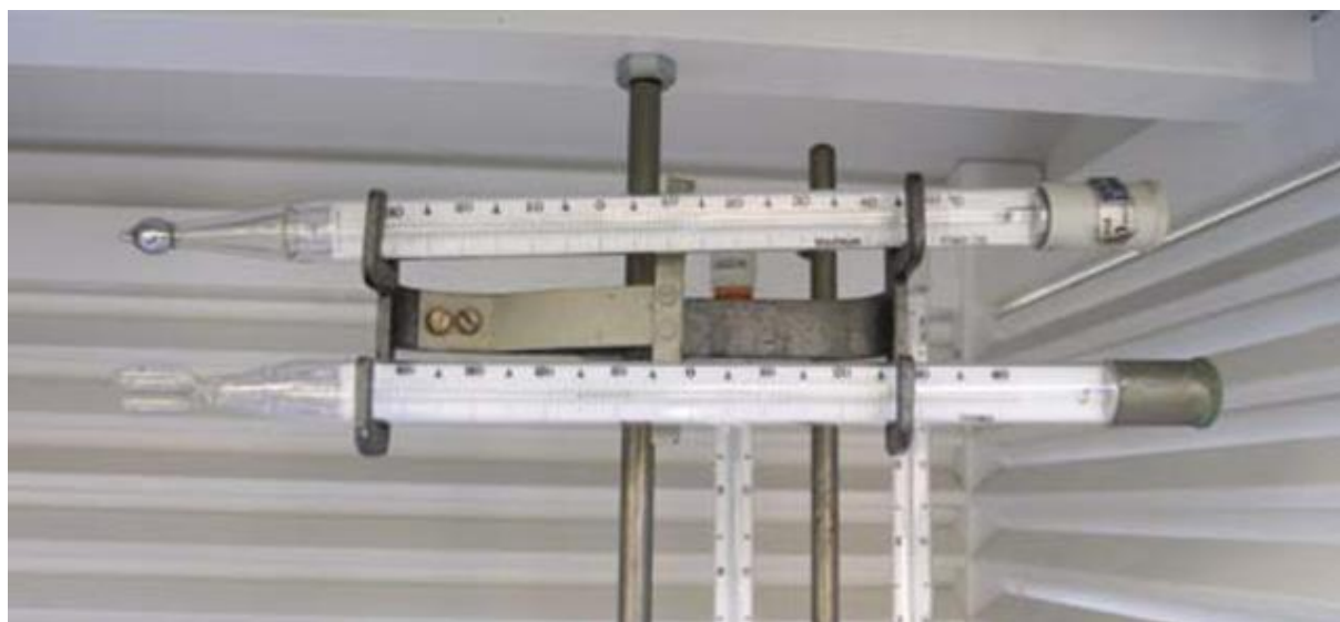
Slika 2. Maksimalni i minimalni termometar (Čačić, 2008).
