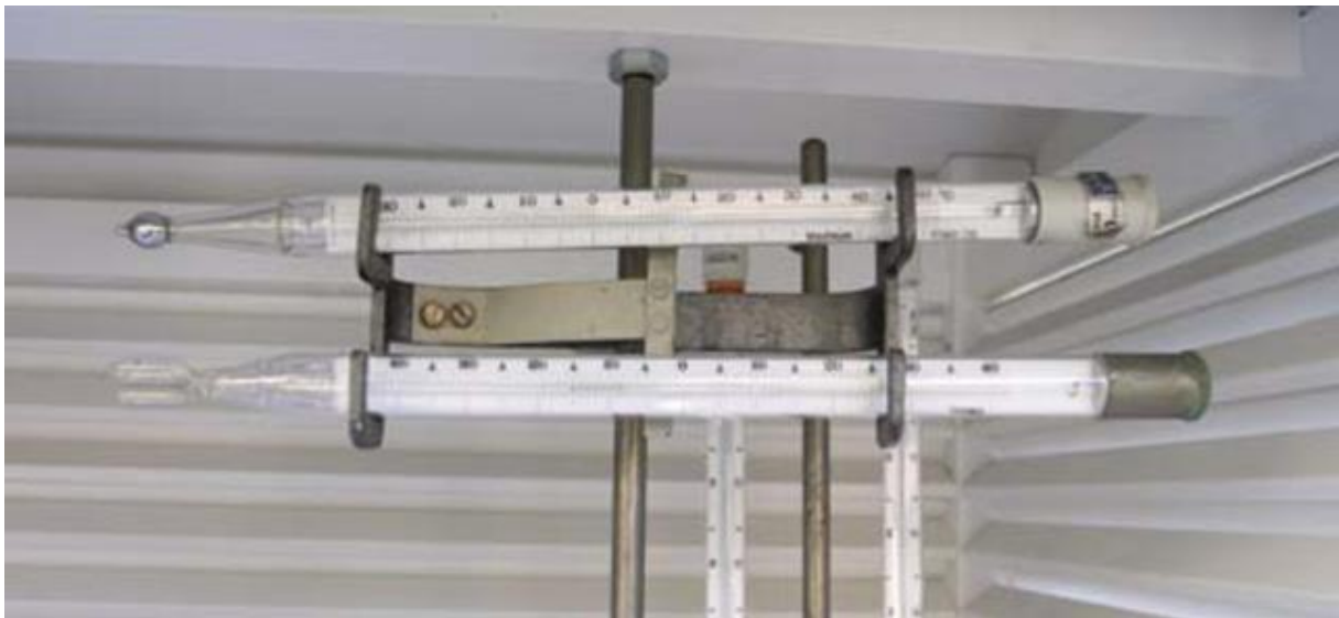
Slika 2. Maksimalni i minimalni termometar (Čačić, 2008).
