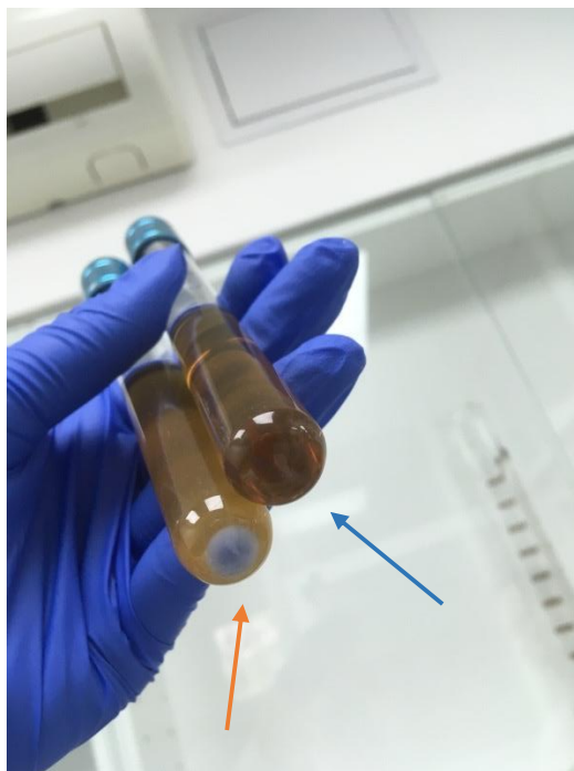
Slika 12. Epruvete s pozitivnim (narančasta strelica) i negativnim rezultatom uzorka na enterokoke (plava strelica).
