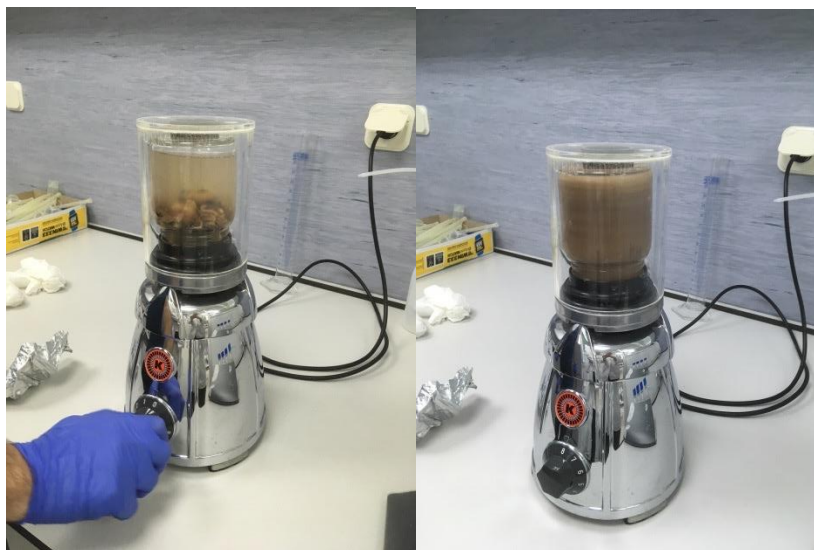
Slika 10. Heterogena smjesa prije homogenizacije ( lijevo ) i homogena smjesa nakon homogenizacije ( desno ).
