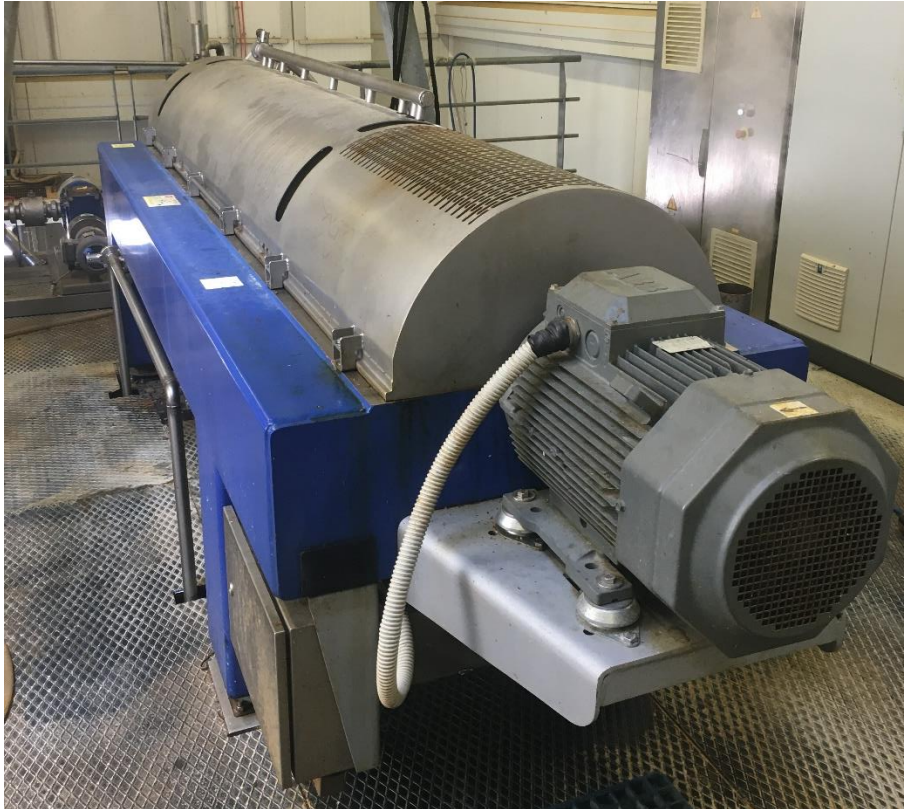
Slika 4.3.1. Dekanter centrifuga tipa AC0303 CentryFish 1000 (Alfa Laval, Søborg, Danska).
