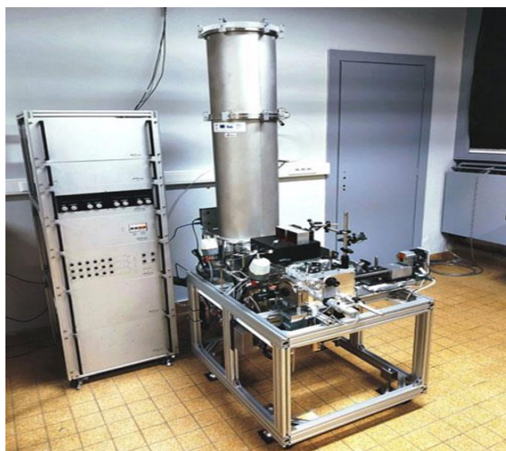
Slika 2.3.6.1. HR-L2MS maseni spektrofotometar - Laboratorij za fiziku lasera, atoma i molekula, Sveučilište u Lilleu (izvor: https://phlam.univ-lille.fr/recherche/pmi/equipements/spectrometre-hr-l2ms ).
