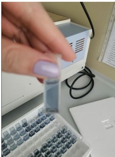
Slika 15. Promjena boje iz žute u plavu tijekom određivanja sadržaja ukupnih fenola.
