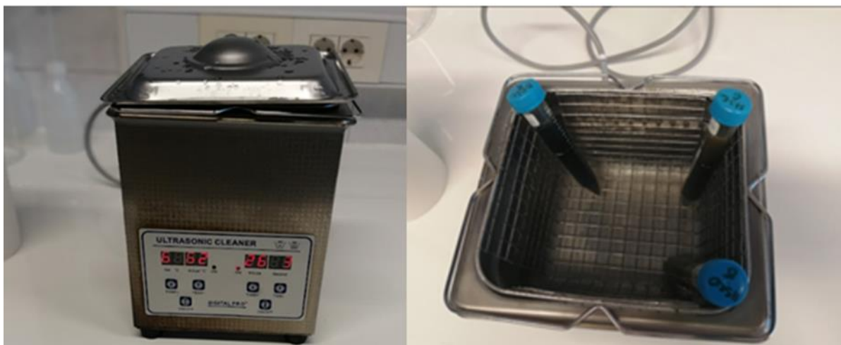
Slika 12. Ultrazvučna kupelj s uzorcima.
