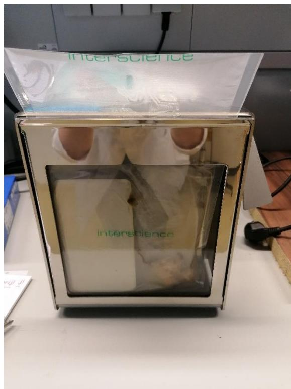
**Slika 6.** Homogenizacija uzorka u homogenizatoru (izvor: vlastita fotografija).
