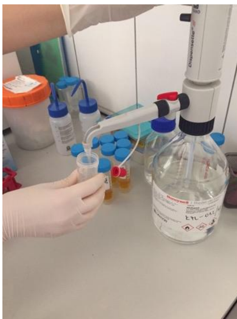
Slika 7. Dodavanje otopine metanola u homogenizirano tkivo brbavica
