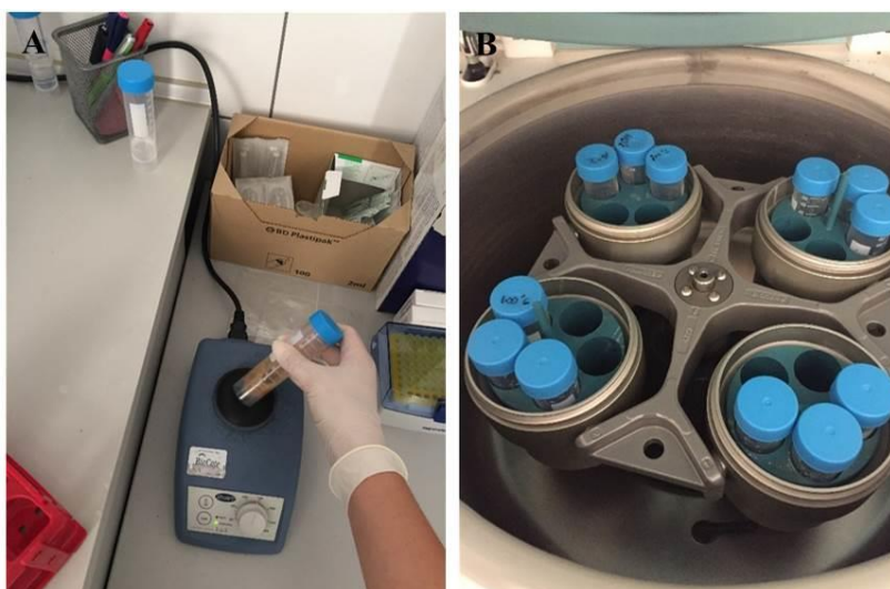
Slika 9. Vorteksiranje uzorka dagnje pri maksimalnoj brzini (A) i stavljanje uzoraka u centrifugu s istim brojem epruveta na svakoj strani (B).
