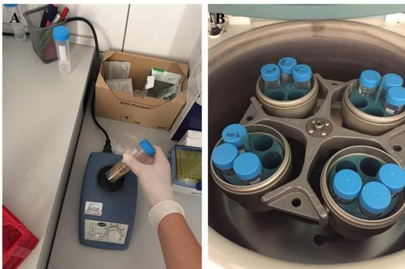
**Slika 9.** Vortexiranje uzorka dagnje pri maksimalnoj brzini (A) i stavljanje uzoraka u centrifugu s istim brojem epruveta na svakoj strani (B).
