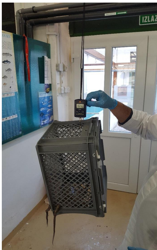
Slika 9. Određivanje mase, vaganjem hobotnica s kavezom.
