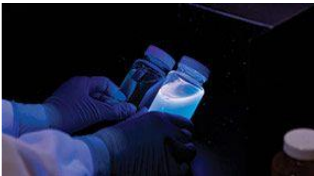
Slika 11. Plava fluroescencija dokazuje aktivnost \beta -D-glukuronidaze, a time i vrstu Escherichia coli (izvor: https://www.idexx.com/en/water/water-products-services/colilert-18/ )
