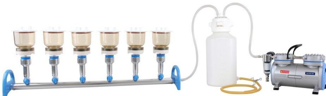
**Slika 8.** Aparatura za membransku filtraciju (izvor: <https://www.rocker.com.tw/product-3.asp?ser=1045&ser2=Laboratory%20Filtration>)
