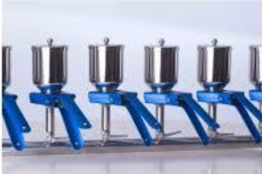
Slika 9. Aparatura membranske filtracije i držači filtera (plavo obojeni) (izvor: http://tr.starlabsci.com/300ml-glass-3-branches-vacuum-filters_p77.html )
