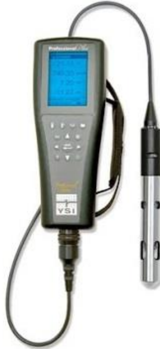
Slika 9. YSI sonda korištena za prikupljanje hidrografskih parametara (izvor: www.geotechnics.co.nz ).
