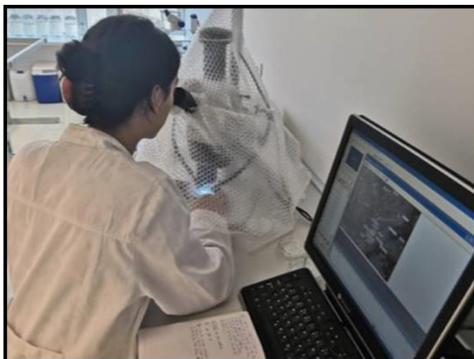
Slika 19. Stereo lupa obložena zaštitnom folijom povezana s računalom (slika: Z. Popović Perković).
