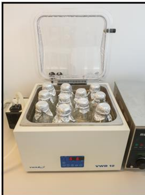
Slika 16. Inkubacija tkiva u vodenoj kupelji na temperaturi od 55 do 65°C, u trajanju od 48h (slika: E. Vranjić).
