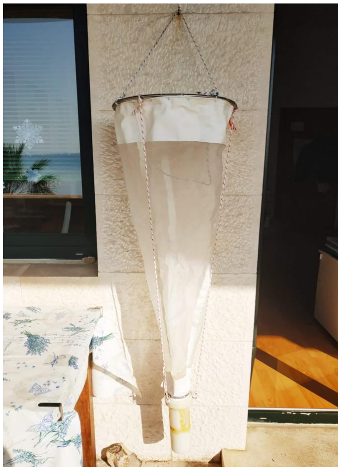
Slika 7. Planktonska mreža za uzorkovanje zooplanktona (Izvor: Marta Skračić).
