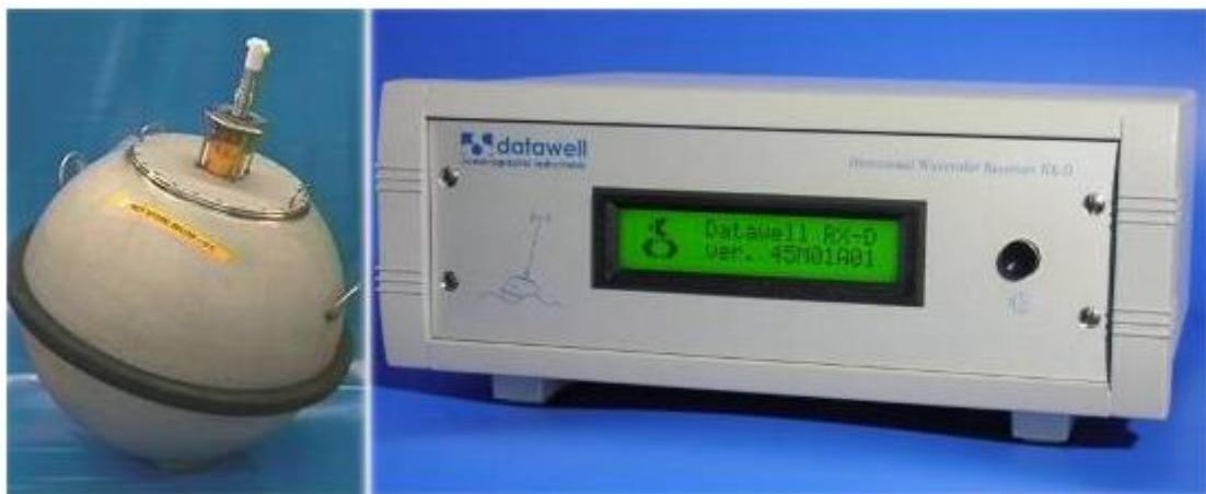
**Slika 5.** Mjerna plutača s odašiljačem i prijemna stanica valomjera tvrtke DATAWELL
