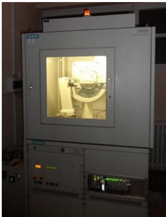
Slika 2.3.7.2. Rendgenski difraktometar za tanke filmove (izvor: Krešimir Salamon).
