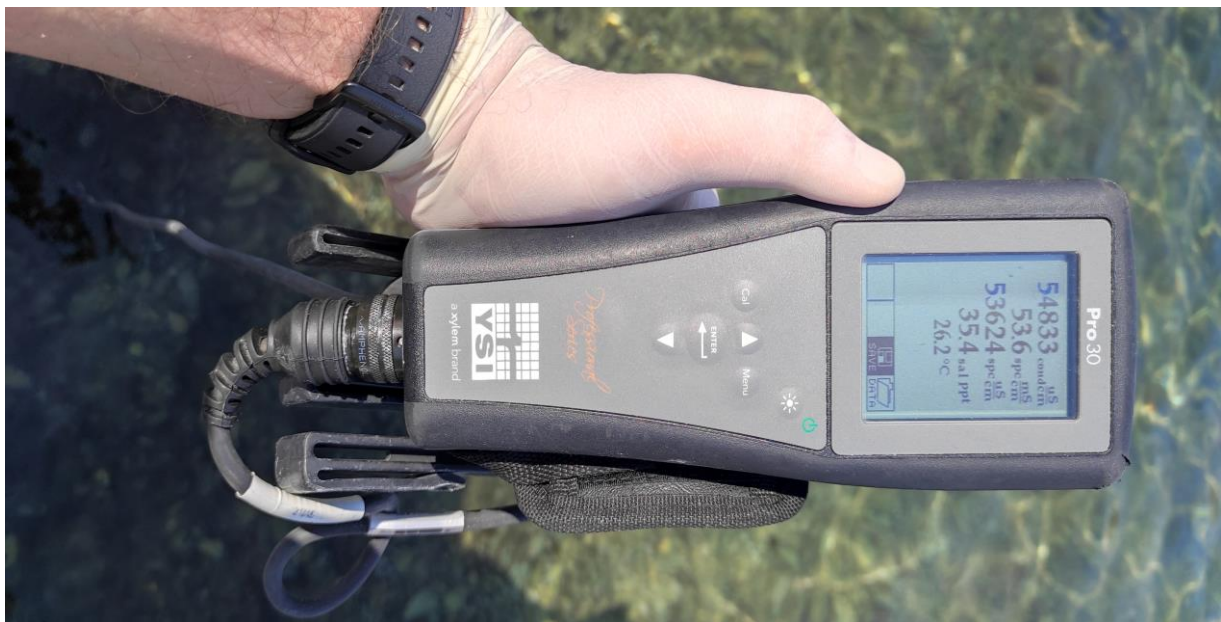
Slika 7. Očitavanje rezultata mjerenja ručne sonde pri prikupljanju uzoraka na terenu
