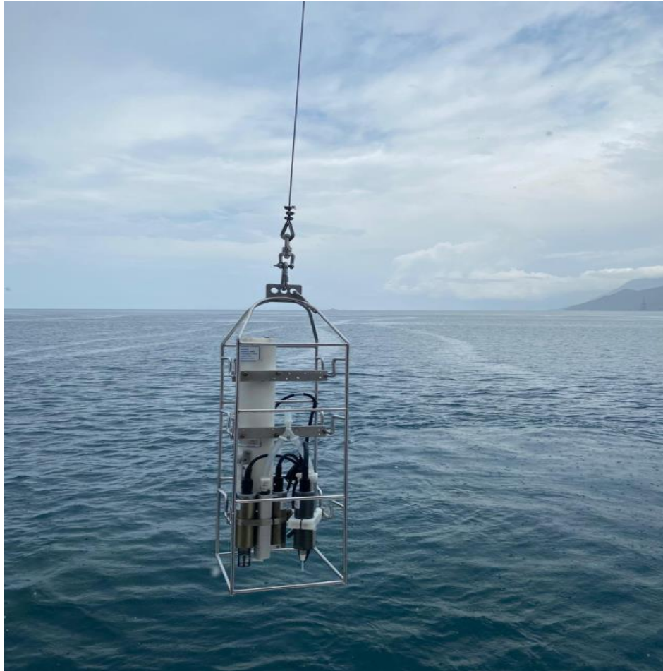
Slika 2. Sonda SeaBird SBE25 u trenutku spuštanja u more. Slika je napravljena tijekom krstarenja u rujnu 2021. godine. (autor: David Udovičić)
