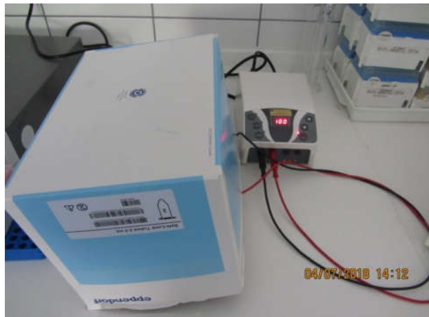
Slika 13. Elektroforeza na agaroznom gelu uzoraka DNA umnoženih Nested PCR reakcijom.
