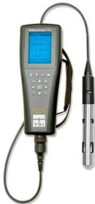
**Slika 9.** YSI sonda korištena za prikupljanje hidrografskih parametara (izvor: [www.geotechnics.co.nz](http://www.geotechnics.co.nz)).
