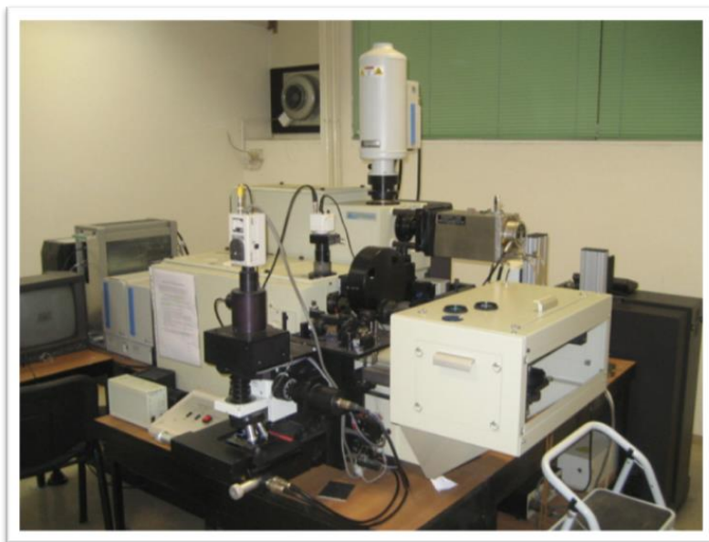
Slika 20. Raman spektrometar T64000 s INNOVA 400 argon laserom (izvor: https://www.irb.hr/ ).
