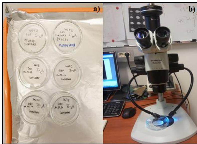
**Slika 18.** a) Filter papiri u petrijevim zdjelicama b) Olympus SZX 10 stereo lupa (slika: E. Vranjić).
