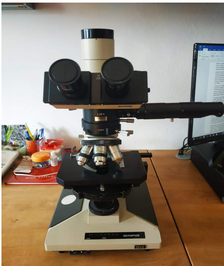
Slika 10. Svjetlosni mikroskop Olympus BH-2 opremljen s cijevi za crtanje („ camera lucida “) (Izvor: Marta Skračić).
